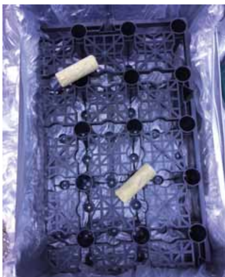
Proef plantenkrat met plastic omhuld, daarin krat met waterabsorberende cones
