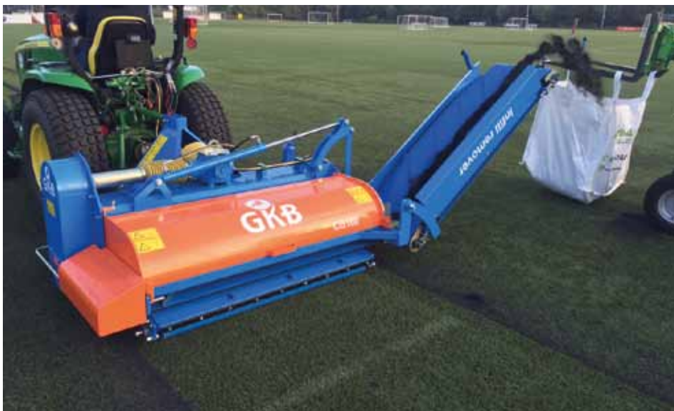
De GKB Infill Remover helpt om al het infillmateriaal uit een kunstgrasmat te verwijderen.
