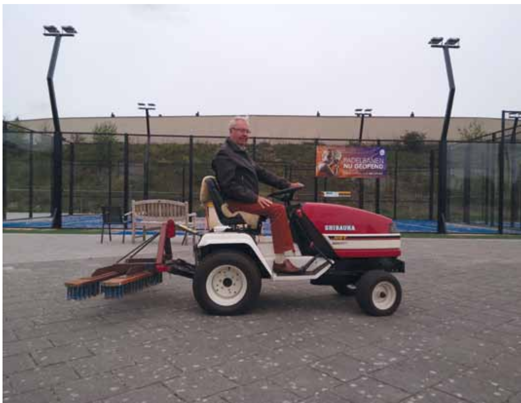
Coolen heeft zijn eigen bezem ontwikkeld om het infill-rood goed te verdelen.
