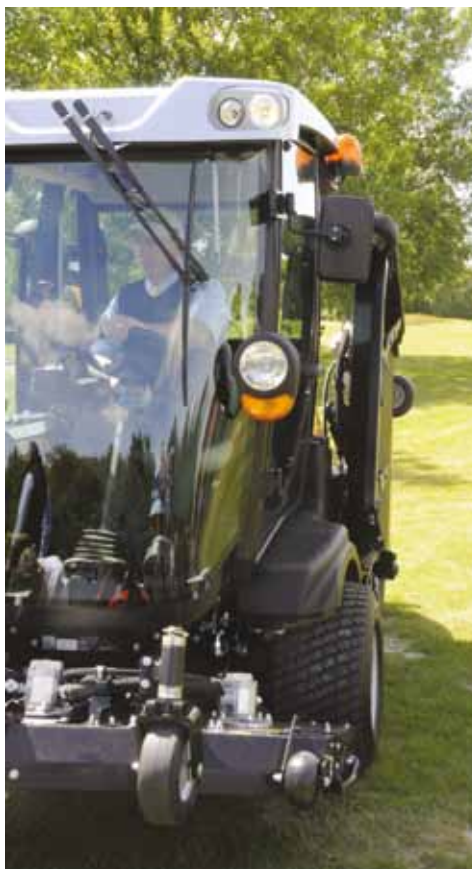
Maaidek klappt weg 'in' de machine, dus geschikt voor smalle doorgangen. Transportbreedte 1,65 meter; volgens Ransomes de smalste in zijn klasse.
