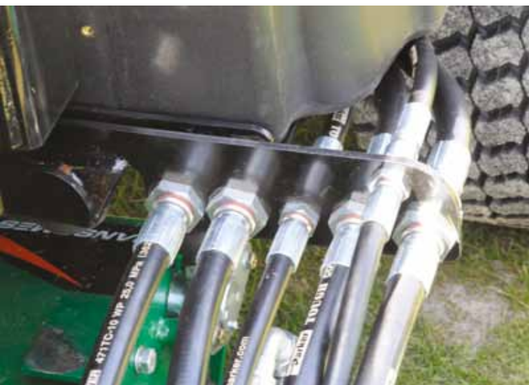
Deze Parker-hydraulieslangen zijn roteerbaar aan de machinekant.
