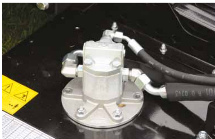
De hydromotoren zijn direct op snijmesses gemonteerd
