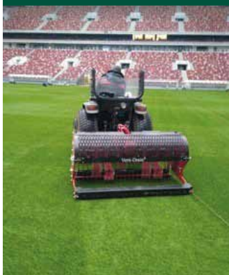
In verschillende stadions werden niet tractoren gebruikt, maar de Redexim Carrier, waaraan dan de onderhoudsmachines werden gekoppeld zoals hier Stadion Nizhny Novgorod met een Verti-Drain model 1513 aangekoppeld. Dit om insporing van de tractor banden tegen te gaan.
