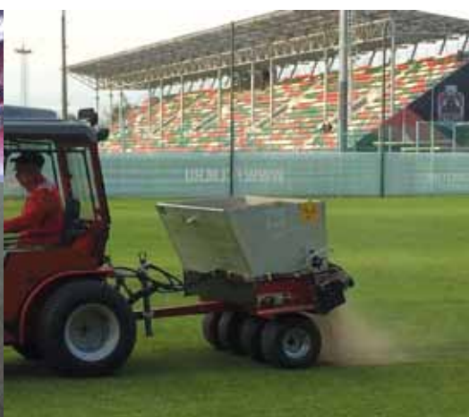
Het Lokomotiv Moskou-stadion dient tijdens het WK als basiskamp voor de scheids - en grensrechters. Fieldmanager Vladislav Lysenko zaaide het veld in het voorjaar in zes richtingen door met de Overseeder 1275 Disc zaaimachine, gevolgd door de Speed-Seed, welke laatste is uitgerust met conische spikes die duizenden gaatjes in de grond prikken waarin het zaad valt, waardoor een dichte grasmat werd verkregen. Alvorens met de Verti-Drain te beluchten wordt eerst een dunne laag zand aangebracht met de Rink-borstelstrooier (foto rechts op naastgelegen oefenterrein).
