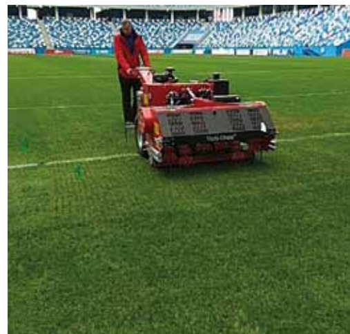
In verschillende stadions werden niet tractoren gebruikt, maar de Redexim Carrier, waaraan dan de onderhoudsmachines werden gekoppeld zoals hier Stadion Nizhny Novgorod met een Verti-Drain model 1513 aangekoppeld. Dit om insporing van de tractor banden tegen te gaan.
