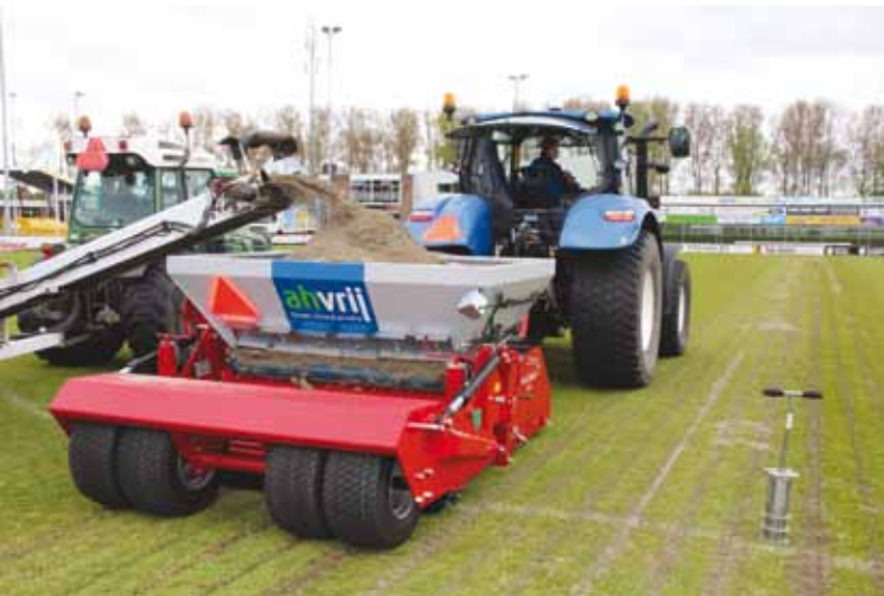
De Vibra-Sandmaster bestaat uit een schudfrees met sleuenvulmachine.
