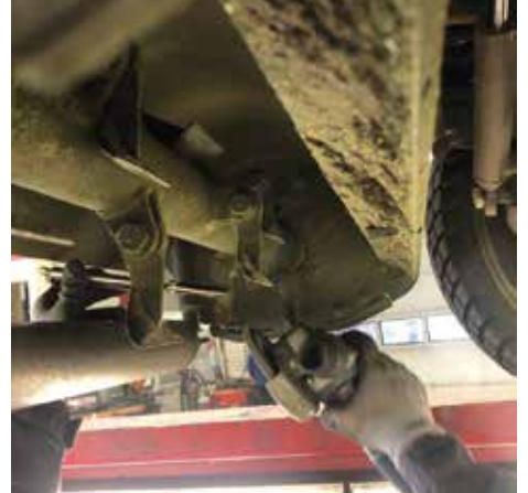
Met de griptang slijpen van de klepels van de Roberine zelfrijdende klepelmaaier
