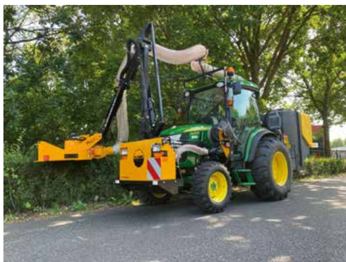
Het RM1250 Pro-dek kreeg in de aansluiting met de zuigslang een trommelhakselaar.
