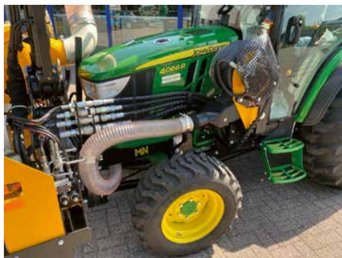
Bij de HagenProfi Gen II staat de hydrauliekpomp achter op het frame. De hydrauliekslangen lopen langs de tractor.
