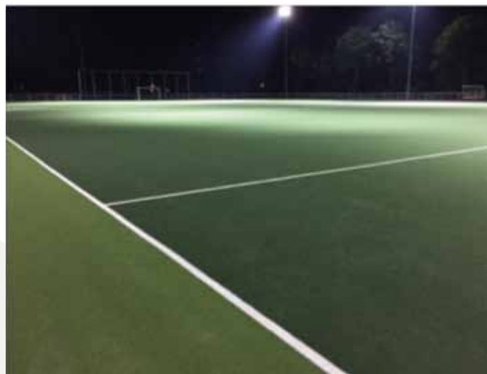
Effect uitval ledmodule bij multispot-verlichting
