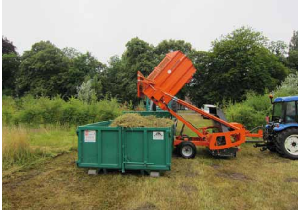
Omdat de machine hoog kiept, heeft hij weinig ruimte nodig bij het legen.
