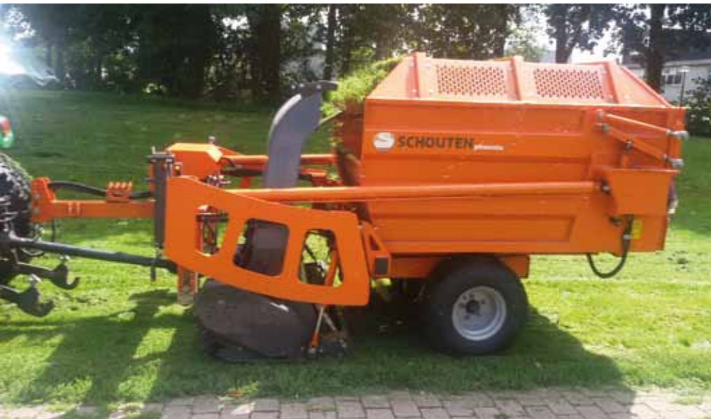
De machine heeft zowel een maai- als een borstelunit.
