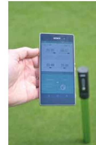
De Pogo is een draagbare bodemsensor die met smartphone uit te lezen is.
