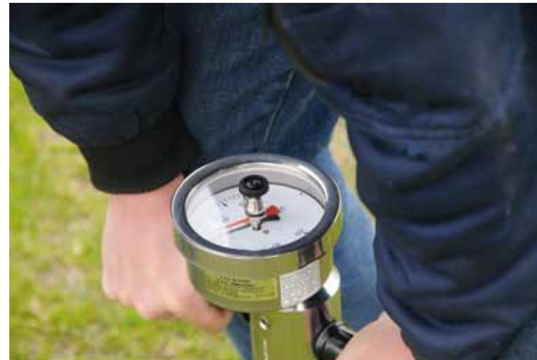
Een penetrometer meet hardheid en doorlaatheid van de grond.
