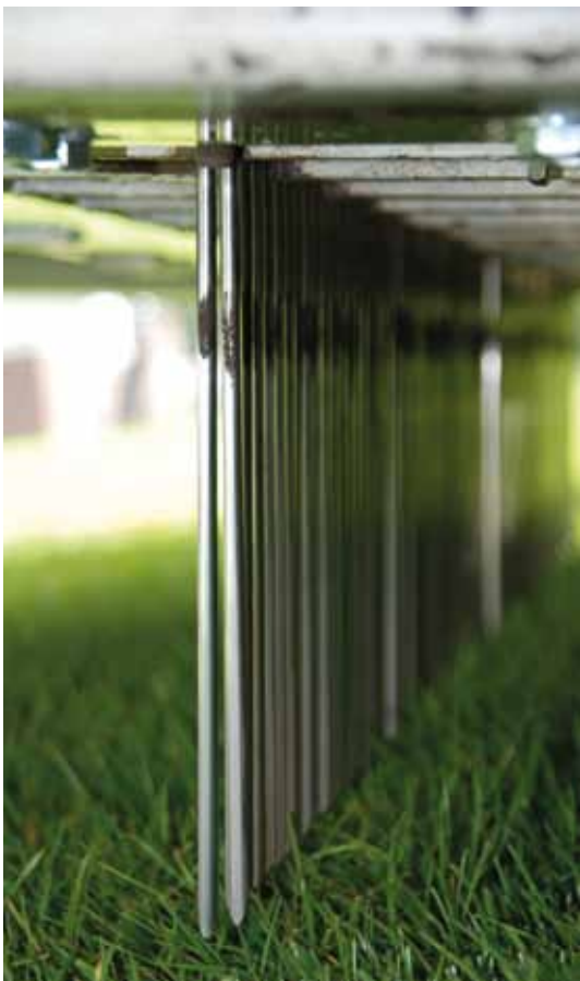
In een Desso GrassMaster-systeem worden de kunstgrasvezels 18 centimeter diep geplaatst.
