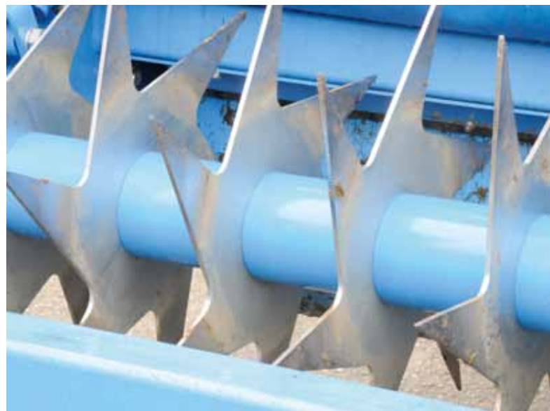
De messen staan 45 graden gedraaid ten opzichte van elkaar en vormen zo een soort spiraal.
