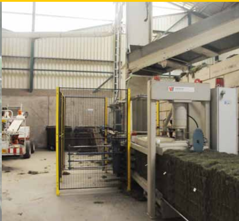
De balenpers, waarmee het gerecyclede kunstgras gereed gemaakt wordt voor transport naar de verschillende afnemers.
