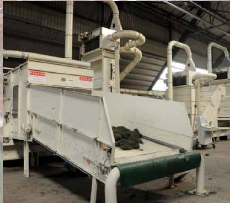
In deze tweede fase wordt de vezel zodanig behandeld dat alle infill-resten en backing verwijderd wordt. Door de batch-gewijze verwerking van de verschillende kunstgrasmatten en wijziging van de machine-instellingen worden er klantspecifieke producten geproduceerd.
