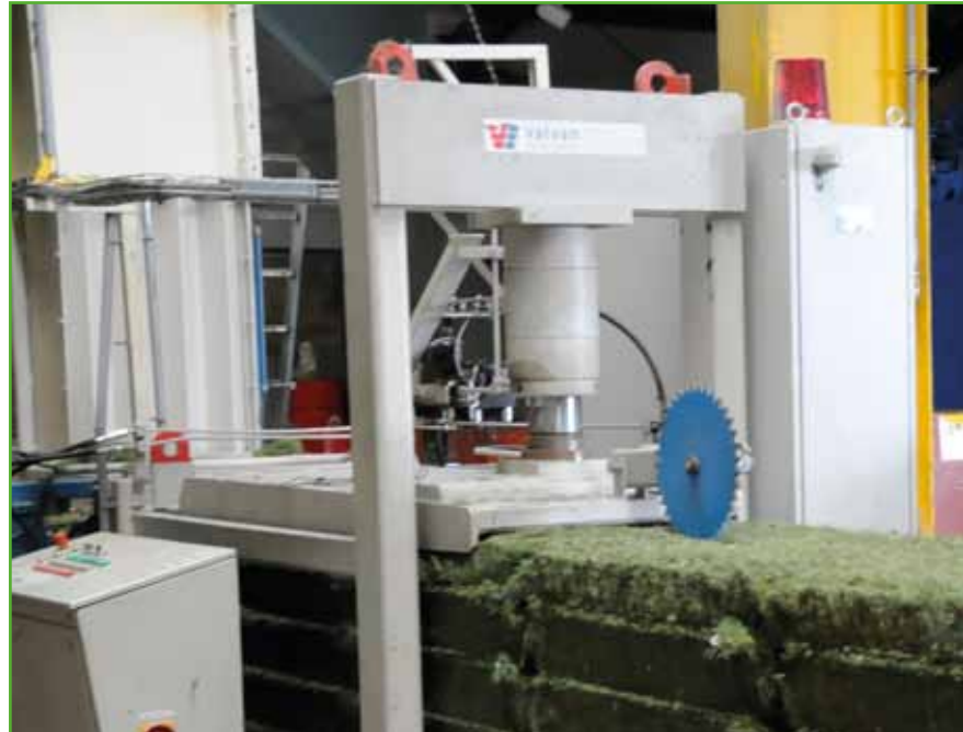
Aan het eind van de verwerkingslijn worden de kunstgrasvezels netjes uit de machine 'gepoept'.
