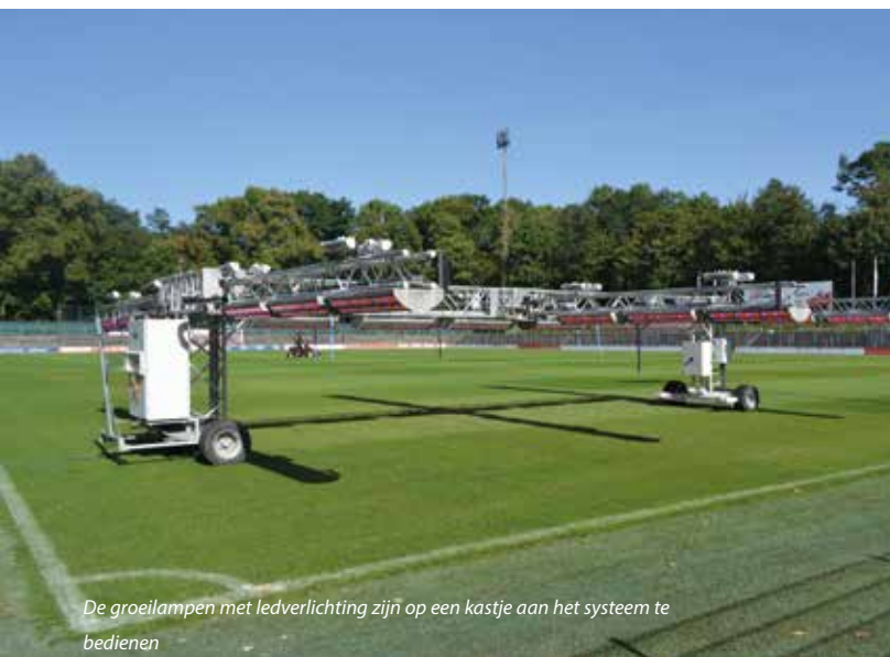
Bovenop de groeilampen is een infrarood-lamp gemonteerd
