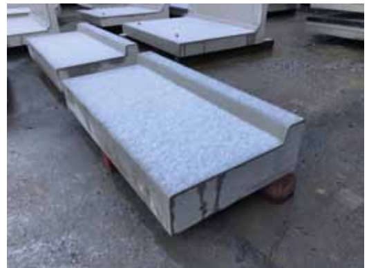
De betonplaat met aan de rand de opstaande rand die bij het project HVCV Quick werd toegepast.
