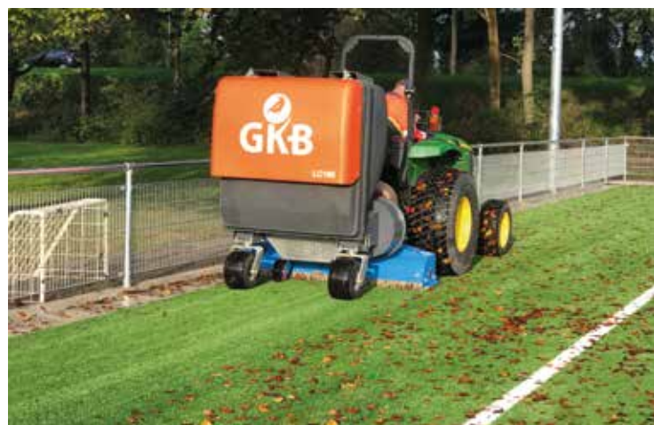
De krachtige ventilator, rechtsachter op de machine, wordt rechtstreeks door de aftakas aangedreven.
