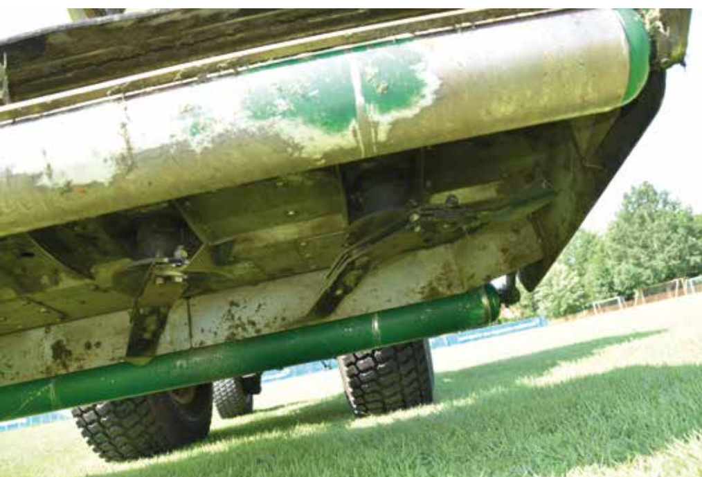
De Major MJ71-190 Roller Mower maait en mulcht met drie degelijke spindels en messen.
