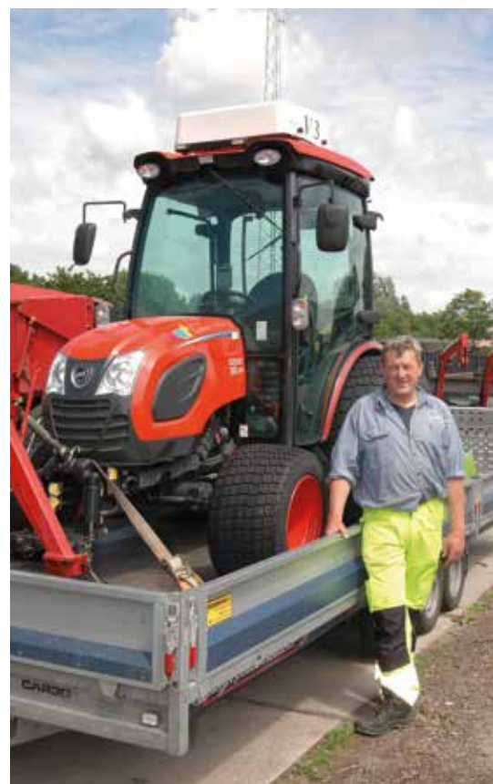
Sybe Postma bij de Kioti CK4010 HST op de aanhanger. Deze compacttractor is vanwege de SBR-infill uitgerust met een luchtdrukcabine.
