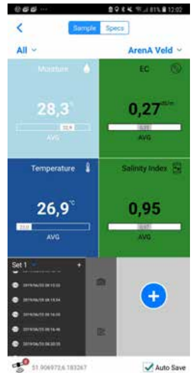
Direct op de drainage meet de vochtsensor 30 procent. Tussen de drainageslangen een paar punten minder.
