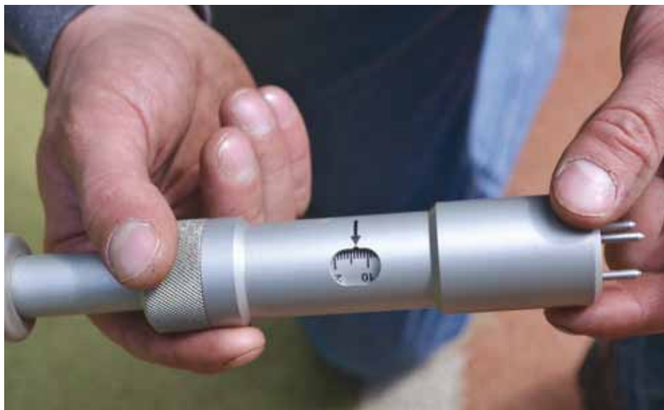
Meten van infill diepte is van cruciaal belang voor behoud van een veld.
