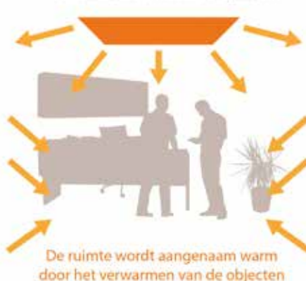
Verwarmen door infraroodpanelen
