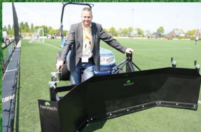
Stef Stempher van Henitech houdt een presentatie over sneeuwruimen. Hij heeft de sneeuwschuiver van Henitech meegebracht, die het veld niet raakt maar sneeuw verschuift met een rubberen flap, hetgeen voor minimale mechanische belasting zorgt.
