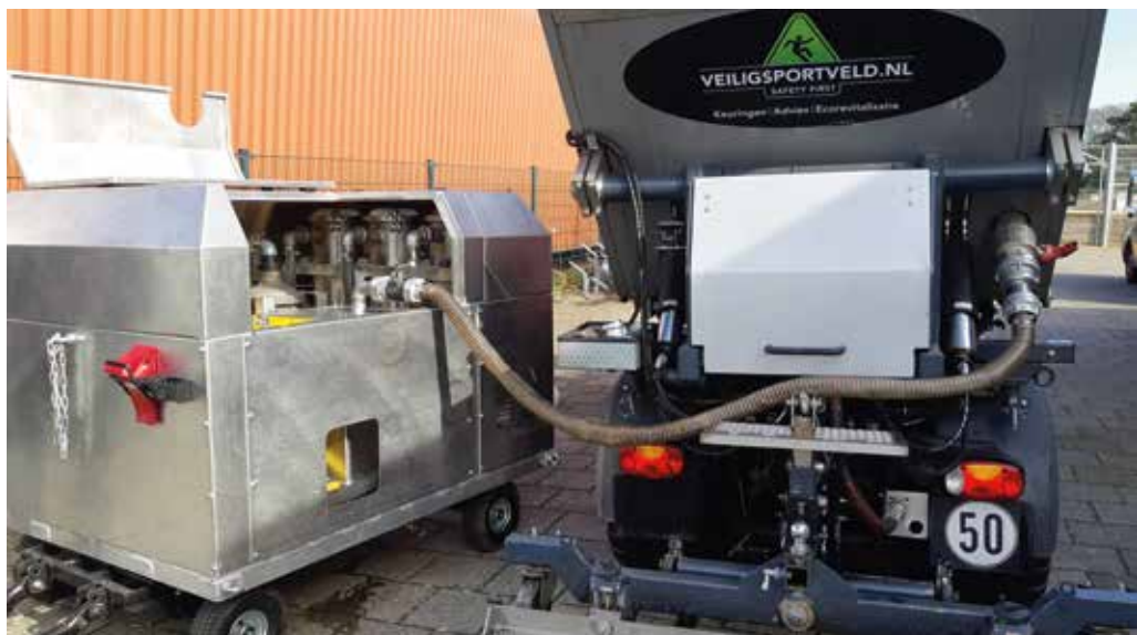
Het vervuilde water wordt met een mobiele unit gefilterd.
