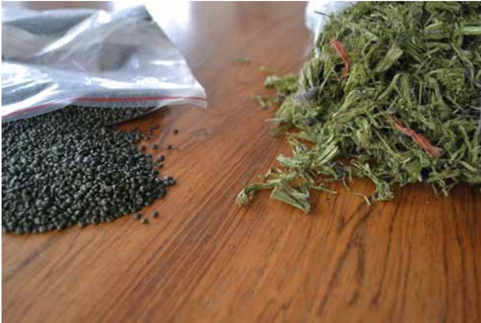
Het granulaat dat gemaakt wordt van oude kunststofvezels en Gerecyclede vezels die opnieuw worden gebruikt, FC Axel.
