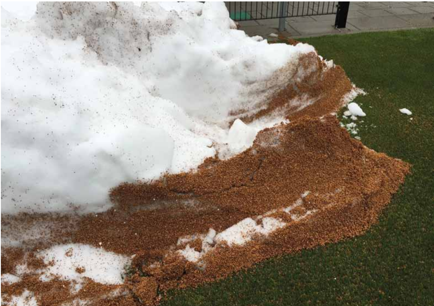
Theo Ceelen meldde het al in zijn praatje: wanneer je een kunstgrasveld met kurk sneeuwvrij maakt, zul je meer infill meenemen dan normaal op een SBR-ingestrooid veld. Op het kurkveld dat op de KNVB-campus ligt, is dat mooi te zien.
