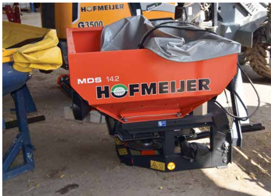
De strooier met twee werpschijven staat klaar voor gebruik in de loods
