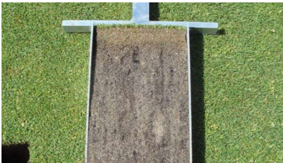
De AGS opteert bij nieuwe greens voor een 80/20 mengsel met organisch materiaal in de toplaag, voor een betere buffering van nutriënten en toch een hoog waterbergend vermogen.
